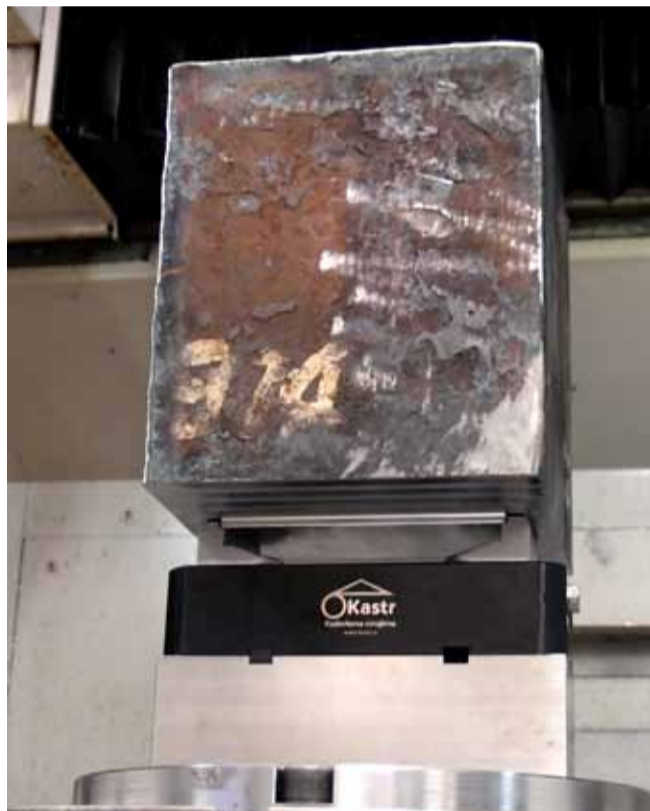
100kilogramový polotovary upnutý za 3 mm do tvrdých čelistí při vyložení 240mm z upínače
