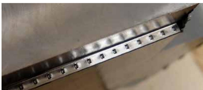
Otisk zoubků bez hydraulického předznačení - mat. ocel
